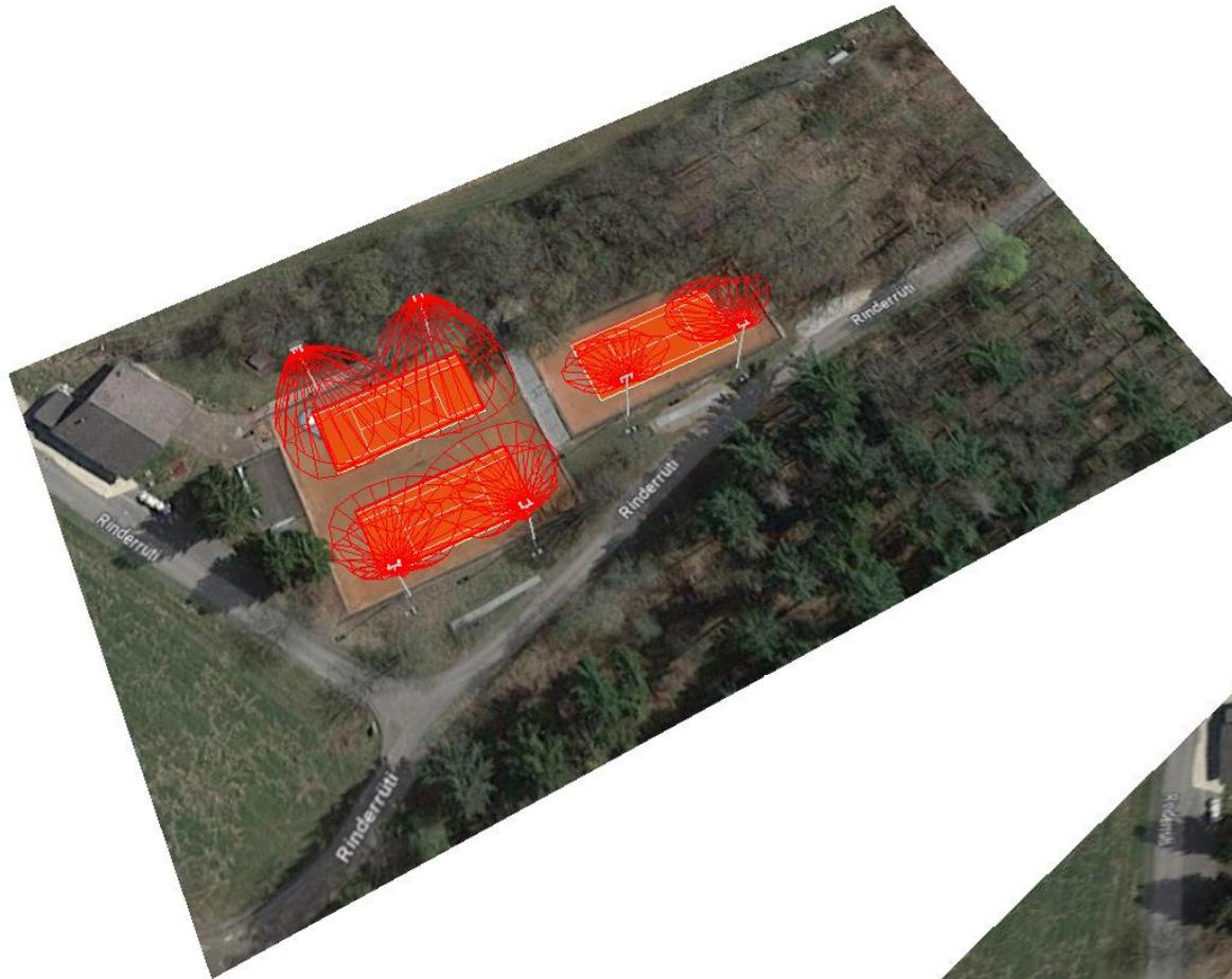
Unsere Lichtberechnung mit 3D-Simulation garantiert die Normenkonformität, eine hohe Gleichmässigkeit bei minimaler Blendung und erbringt den Nachweis der Erfüllung aller Auflagen.
