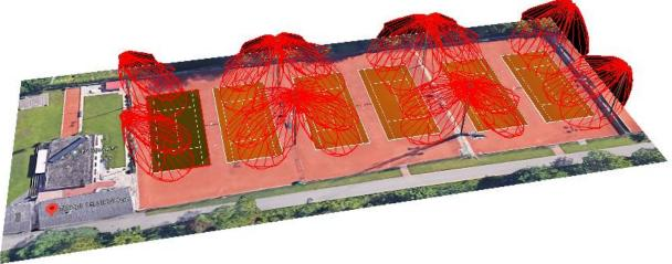
Unsere Lichtberechnung mit 3D-Simulation garantiert die Normenkonformität, eine hohe Gleichmässigkeit bei minimaler Blendung und erbringt den Nachweis der Erfüllung aller Emissionsauflagen.
